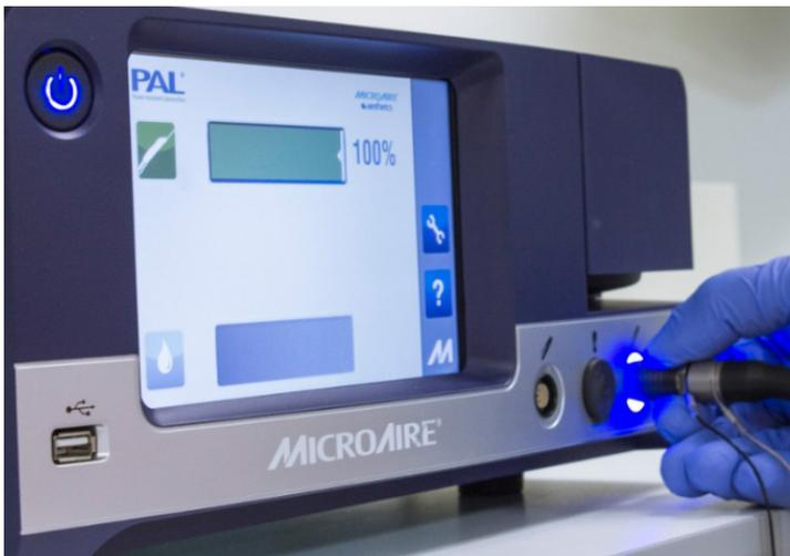
1. Inspeccione la pieza de mano, la consola, el cable y las cánulas en busca de corrosión, daños, desgaste excesivo o humedad residual antes de cada uso.
